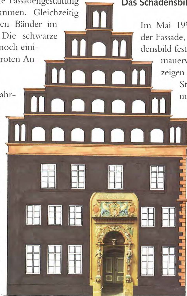
Abb. 2 Rekonstruktion des 18./19. Jahrhunderts mit schwarzem Anstrich und Veränderungen im Erdgeschoss und an den Sandsteinbändern
