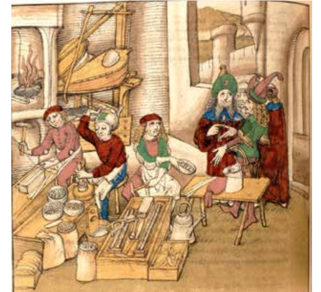
Abb. 3: Blick in eine Münzwerkstatt. Münzknechte bei der Arbeit: von links nach rechts Aushämmern der Zaine, Prägung mit Ober- und Unterstempel, auf einer Werkbank eine Benehmschere, im Hintergrund Schmelzofen und Doppelblasebalg. Diebold Schilling: Spiezer Chronik, Bern 1484/85 (Bern, Burgerbibliothek, Mss.h.h.I.16, p. 222).
