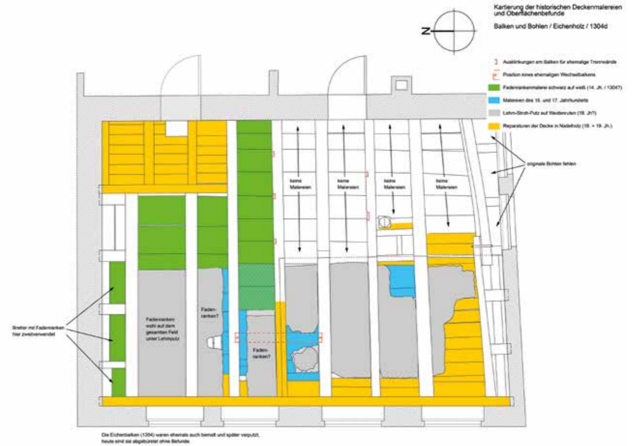
Abb. 7: Kartierung der historischen Oberflächenbefunde im ersten Obergeschoss (Zeichnung: Tillwick / Planzeichnung: HSR-Architekten Lüneburg 2018).
